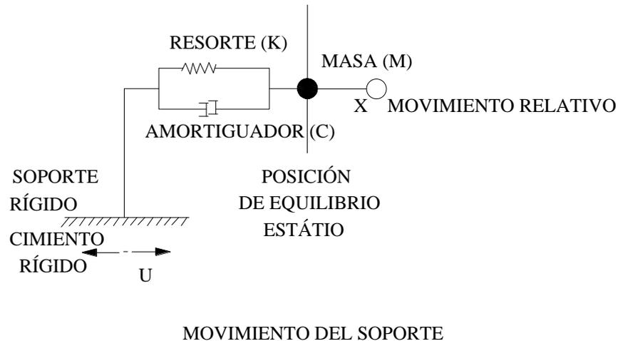
Figura 6-33 Representación de una estructura mediante un sistema de un grado de libertad sin interacción
