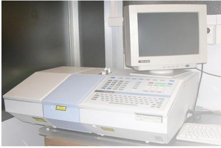
Los espectrómetros miden en % de transmitancia (T) y absorbancia (A). El porcentaje de transmitancia se refiere a la cantidad de radiación que pasa a través de la muestra y alcanza el detector. Una solución límpida, no absorbente, mostrara una lectura de 100% de transmitancia en un espectrofotómetro calibrado. Las unidades de absorbancia van de 0 a 2. La absorbancia se relaciona con la transmitancia.
