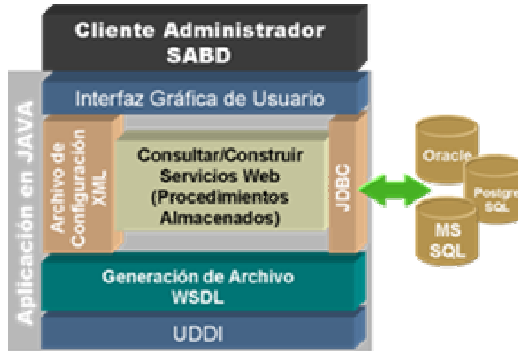
Figura 3.5 Arquitectura para el Módulo Administración/Configuración
