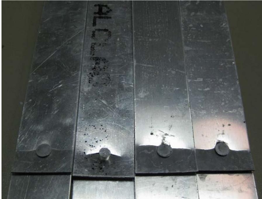
Figura 4.12. Especímenes después de los ensayos de nucleación y crecimiento de grietas por corrosión-fatiga. De izquierda a derecha las dos primeras se cargaron al aire libre y las dos últimas inmersas en ambiente
