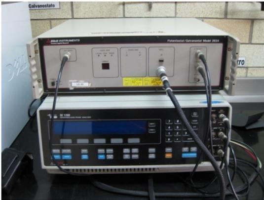
*Figura.3.5. Potenciostato-Galvanostato empleado en las pruebas.*
