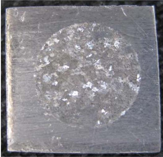
*Figura 4.9. Muestra PP3 después de la polarización potenciodinámica.*
