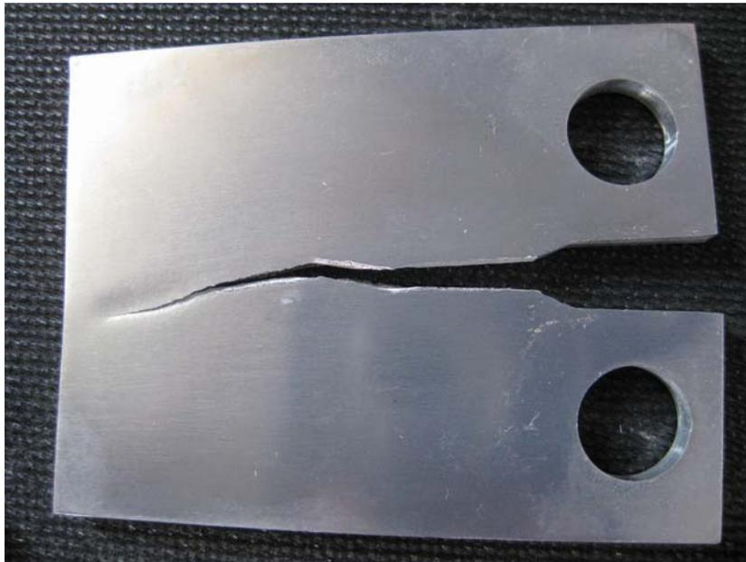
*Figura 4.1. Probeta CT1 después de la prueba de crecimiento de grieta por fatiga.*
