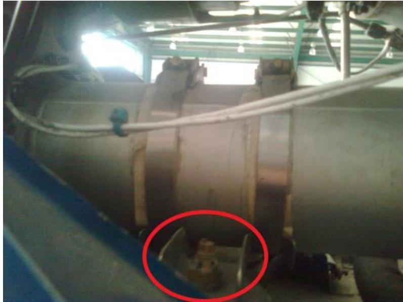
Figura 9. Ubicación de soporte. En la figura se muestra el punto de apoyo de la herramienta soporte de viga así como el eje del motor que se debe mantener equilibrado.
