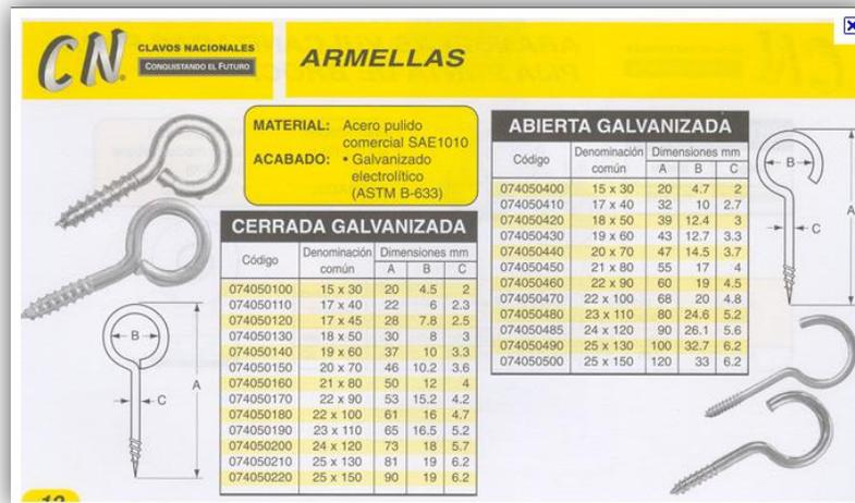
Figura A5: Distintas dimensiones en armellas fabricadas en acero 1010[6].
