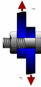
Figura A3 [5] fuerzas cortantes debidas a una carga aplicada
