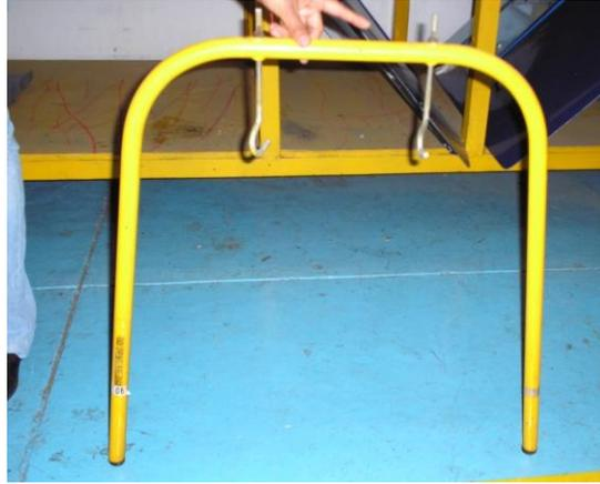
Figura 14 Soporte para manipulación del M-05.
