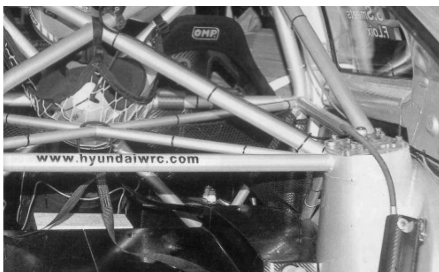
Figura 1. El chasis tubular como refuerzo del vehículo*
