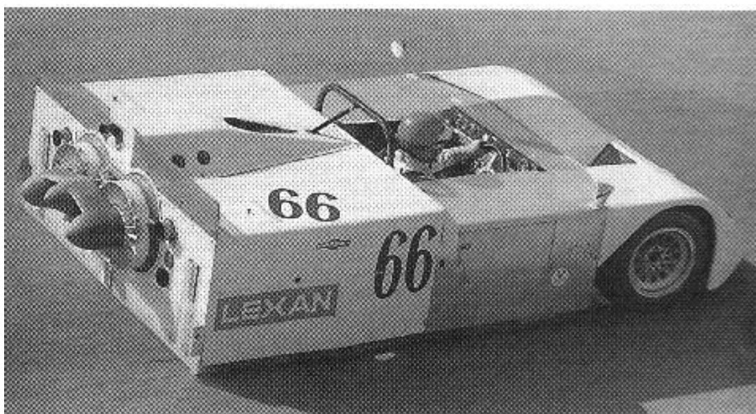
Figura 8: La superficie posterior es mayor y hace que el centro de presiones esté por detrás del centro de gravedad. La conducción es más estable. **
