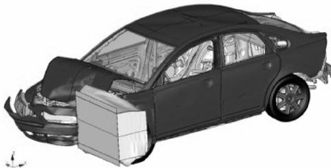
Figura 16: Simulación de Impacto Frontal*
