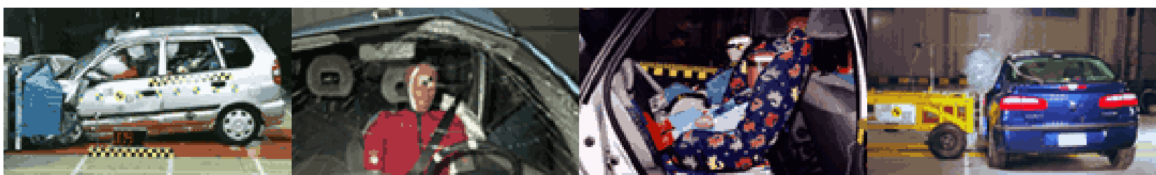
Figura 11. Pruebas de Impacto frontales y laterales realizadas por EuroNCAP*
