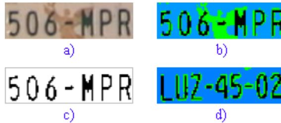
**Fig. 3.** Algoritmo K-means: a) Imagen original; b) Imagen después de aplicar el algoritmo de K-means con  $K = 3$ ; c) Imagen binaria; d) Imagen de la placa del Estado de México, después de aplicar el algoritmo de K-means con  $K = 3$ .
