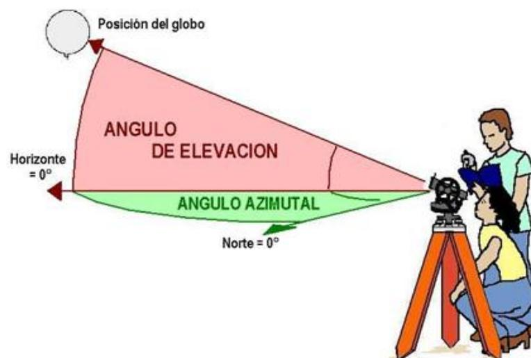
Figura.1.5. Determinación de la posición del globo sonda mediante el uso de un teodolito meteorológico.
