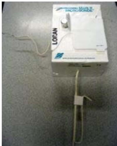
Figura 1.2. Radiosonda Meteorológica
