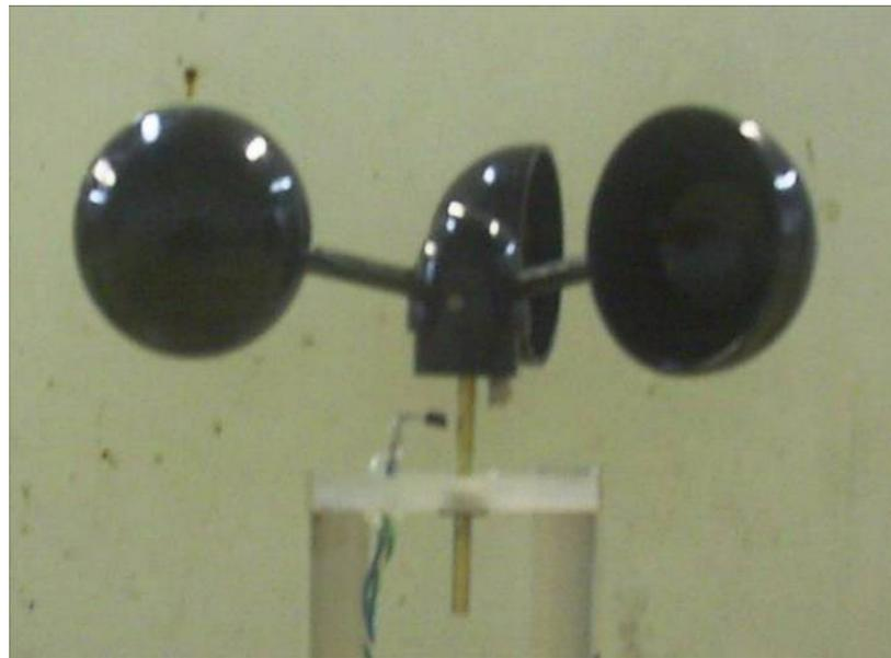
Figura 5.15 Montaje del Anemómetro de copas
