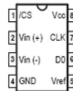
Figura 5.24 Conexión del ADC0831
