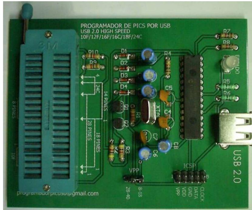
Figura 3.18. Programador por USB
