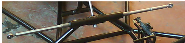
Figura 29- Ensamble de brazos de la dirección.
