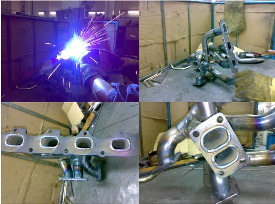
**Fig. 102 Sellado de los puertos mediante soldadura**
