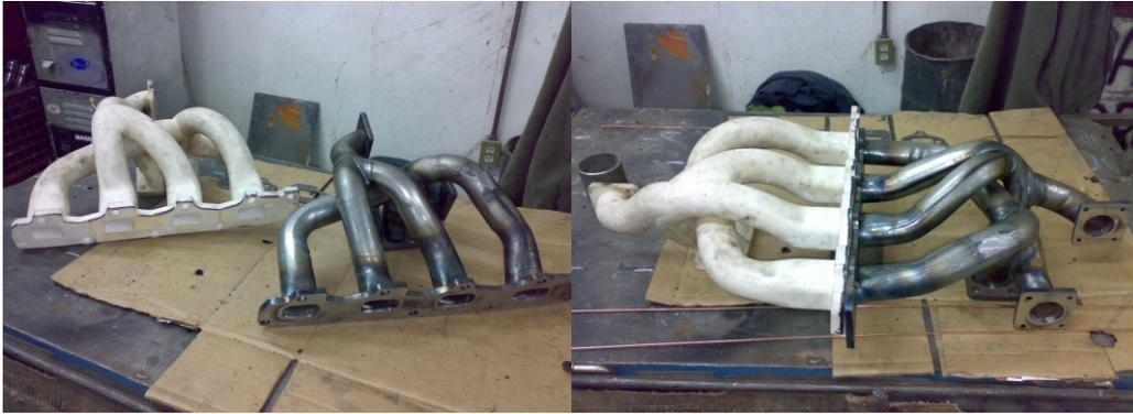
**Fig. 106 Comparación del prototipo rápido y el múltiple de metal**
