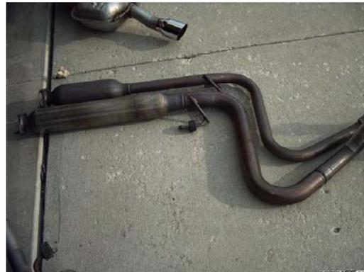
**Fig. 15 Tubos de escape originales del Ecotec. Ref.9**
