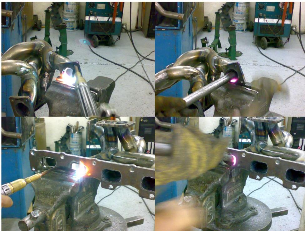
**Fig. 101 Ajuste de los tubos en los puertos de las bridas**
