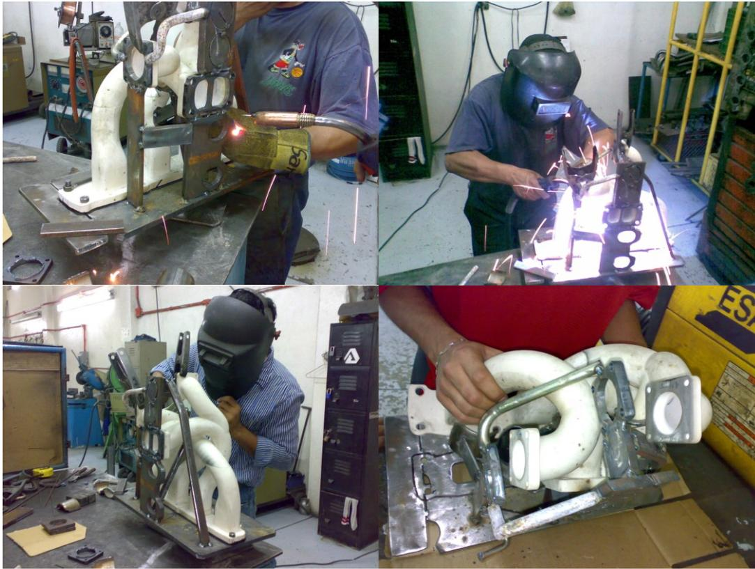
**Fig. 94 Construcción del escantillón**
