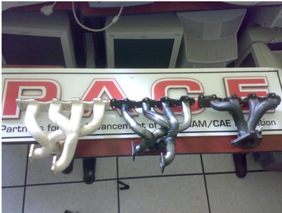
**Fig. 107 Prototipo rápido, múltiple para turbo y múltiple original**
