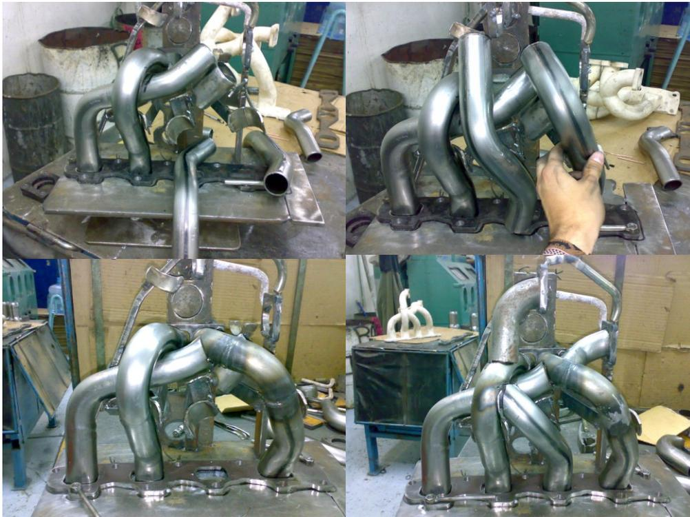
**Fig. 98 Ajuste de los tubos doblados en el escantillón**
