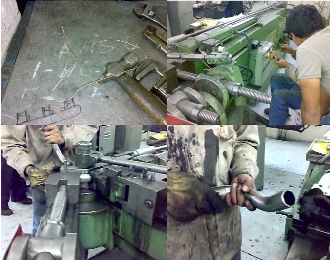
**Fig. 96** Doblado de los tubos a partir de alambres curvados
