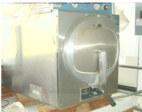
**Fig.6.3.** Autoclave MARKET FORGE modelo Sterilmatic Sterilizer.
