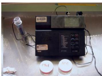
**Fig.6.4.** pHmetro marca ORION.
