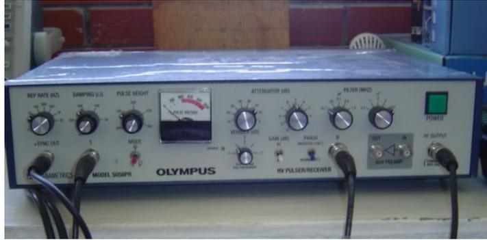
**Fig.6.9.** Equipo emisor-receptor de ondas ultrasónicas marca OLYMPUS.
