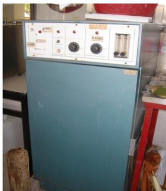
**Fig.6.6.** incubadora marca LAB-LINE modelo 417 vip utilizada en la prueba preliminar.
