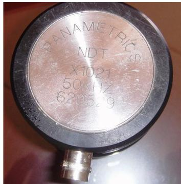
**Fig.6.11.** Transductor marca PANAMETRICS modelo NDT X1021
