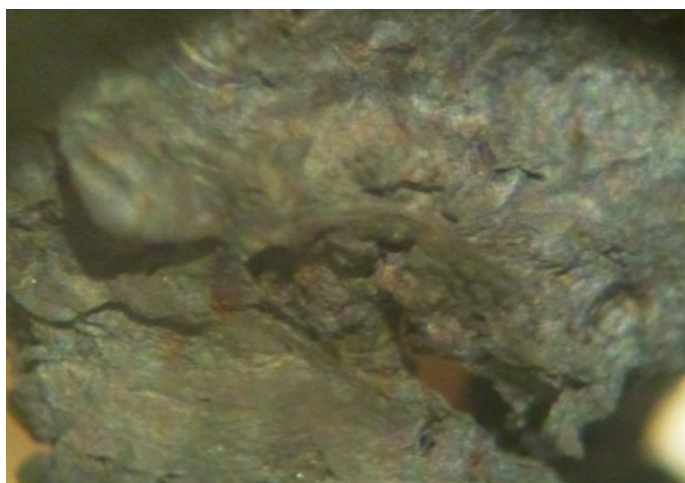
Fig. 7.16. Morfología de la muestra obtenida posterior a la Os por aire después de 1.5 hrs.
