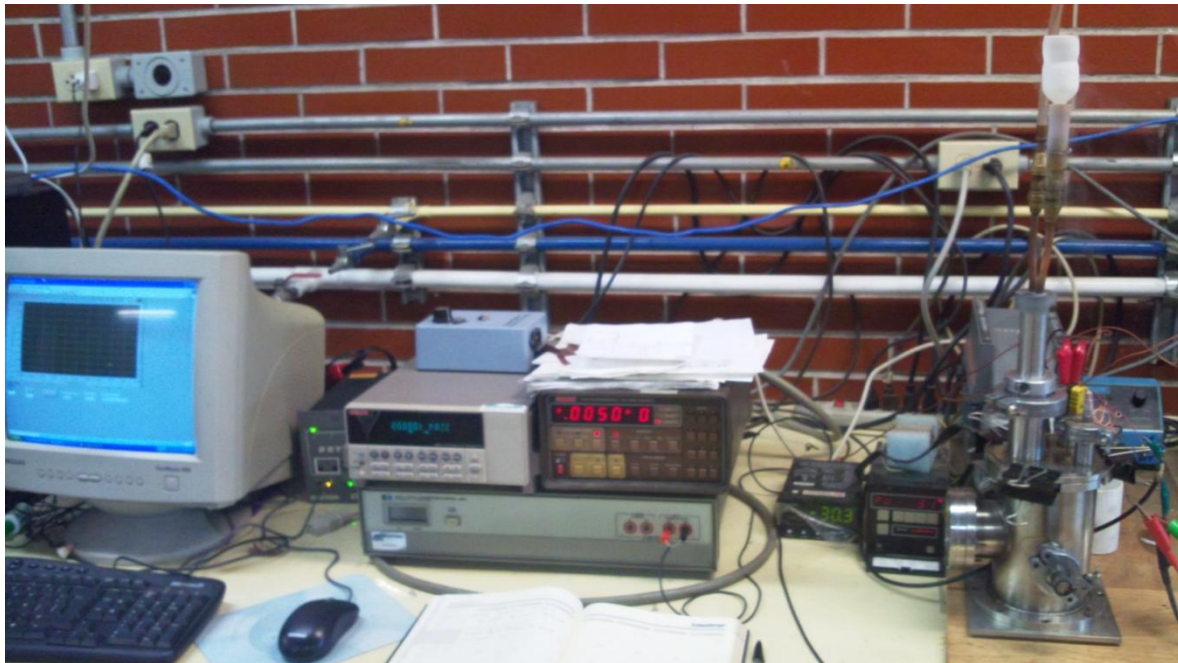
Fig. 6.3. Sistema de medición de la dependencia eléctrica contra la temperatura de laboratorio PLASNAMAT del IIM de la UNAM
