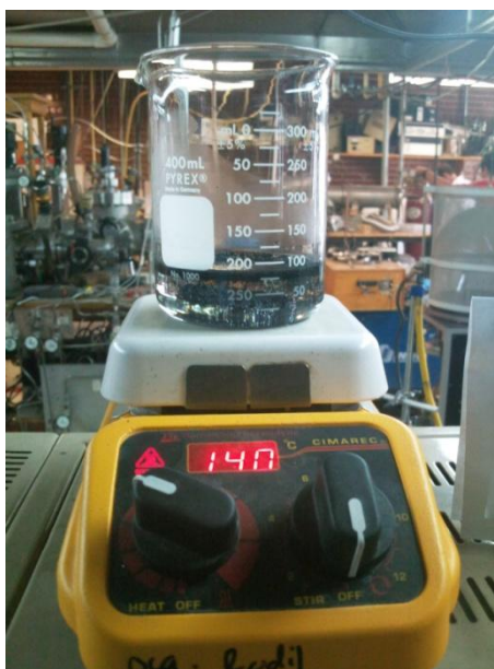
Fig. 4.5. Fotografía del sistema de oxidación OS en fase líquida
