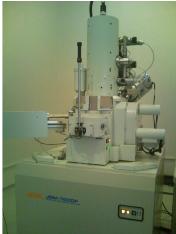
Fig. 3.11. Microscopio Electrónico de Barrido de emisión de campo del IIM de la UNAM
