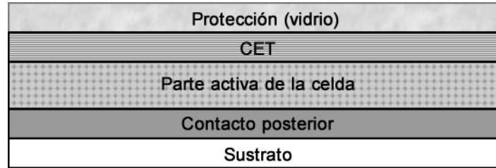
Fig. 1.8. Estructura básica de una celda solar.
