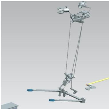
Figura 5.39 Conjunto de control del rotor principal
