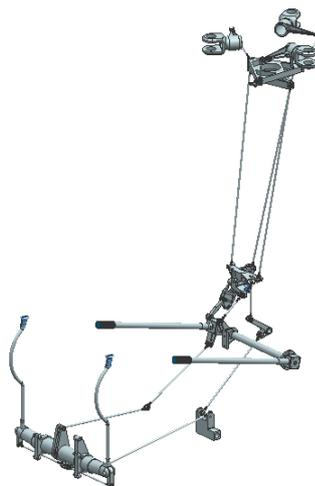
Figura 5.5 Ensamble, conjunto de control del rotor principal
