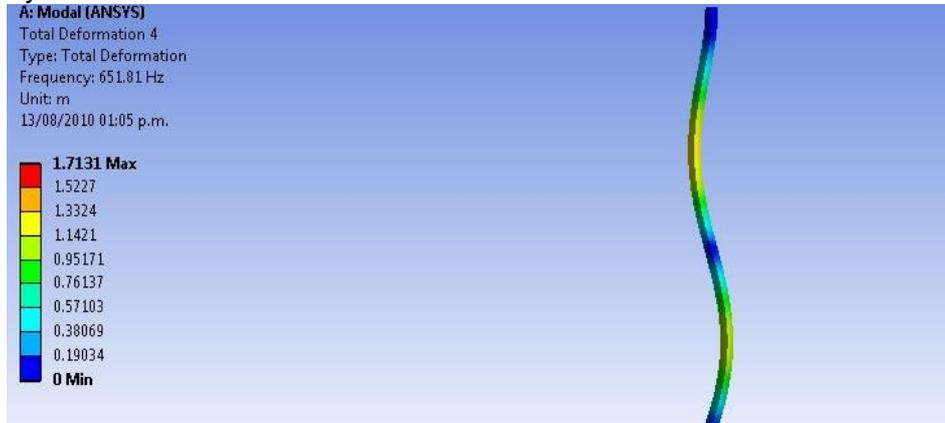
Figura 2.49 Deformacion de la pala en el cuarto modo de vibracion
