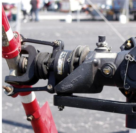
Figura 5.2 Mecanismo de cambio de paso del rotor de cola
