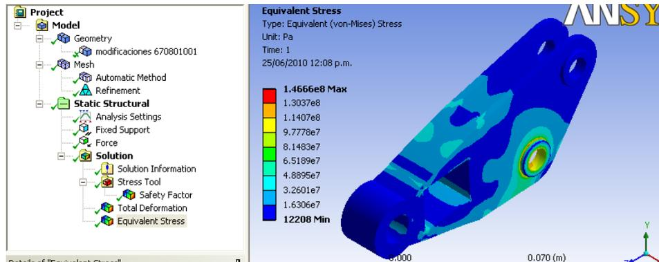
Figura 5.32 Propuesta para 67-08-01-001 (esfuerzo máximo de 1.466e8 Pa)
