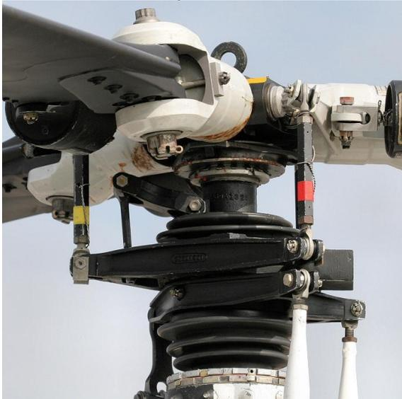
Figura 5.1 Mecanismo de cambio de paso cíclico y colectivo
