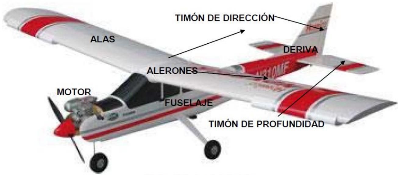
Figura 2. Partes de un avión.
