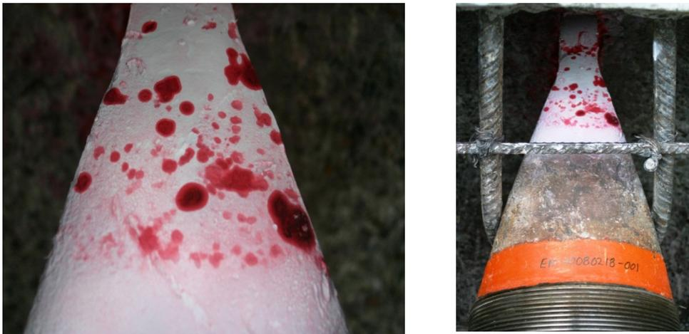
**Figura 2.2** Prueba no destructiva con líquidos penetrantes para determinar defectos y porosidades
