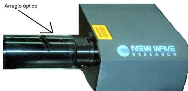
Fig. 2.4 Arreglo óptico integrado para producir la hoja de luz
