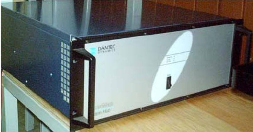
Fig. 3.12 Dispositivo sincronizador del sistema PIV (HUB)
