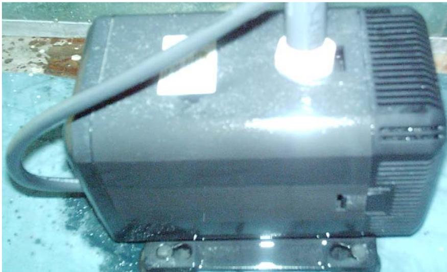
Fig. 3.4 Bomba sumergible de ¼ HP
