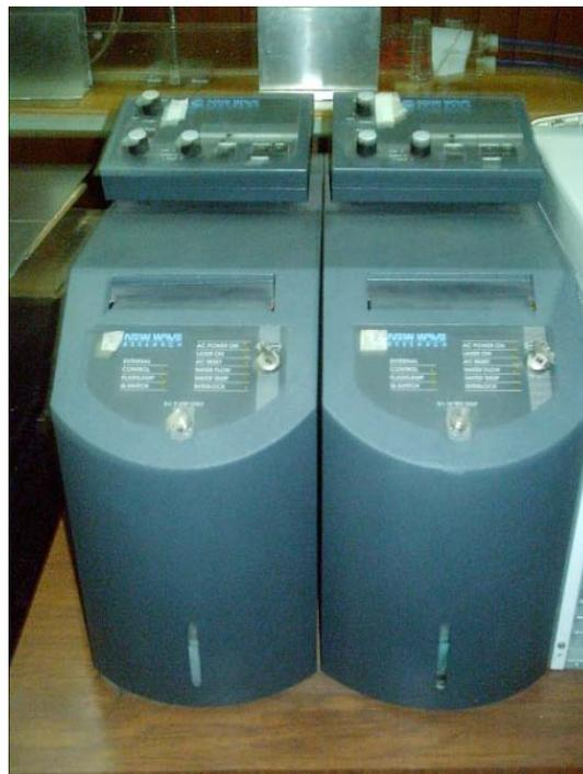
Fig. 3.11 Fuente de poder del laser ND: YAG
