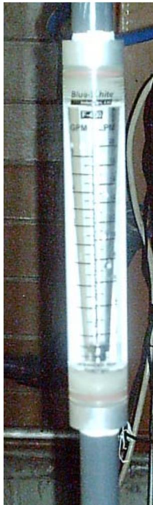
Fig. 3.7 Rotámetro graduado en LPM
