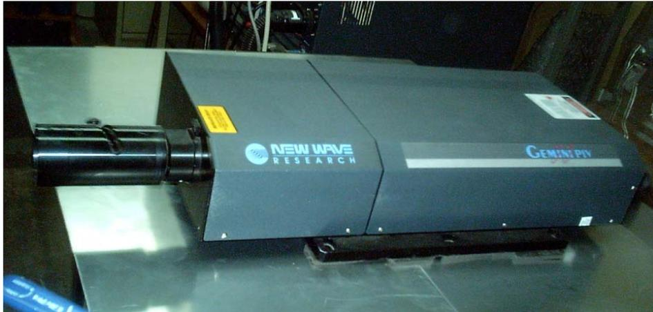
Figura 3.10 Láser Nd: YAG de la marca New Wave Gemini
