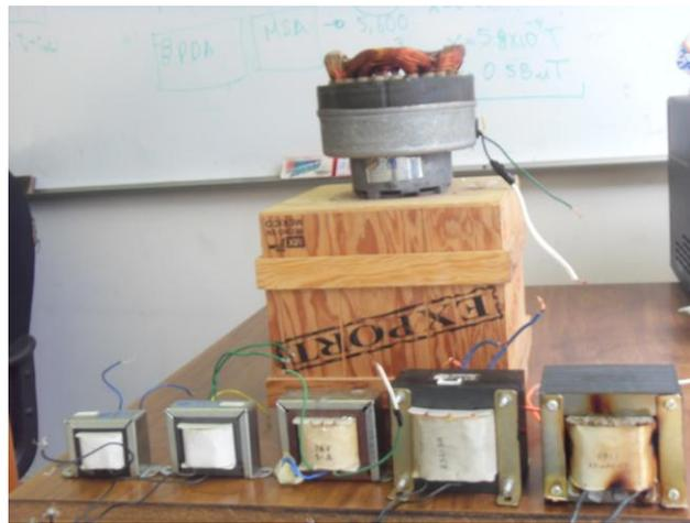
**Figura 3.23** Elemento irradiador y diferentes tipos de transformadores utilizados en cada tratamiento.
