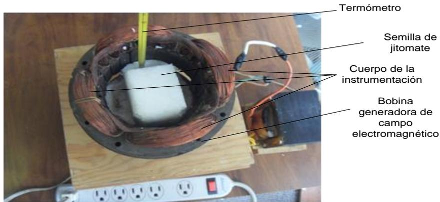
**Figura 3.22** Partes del elemento irradiador.
