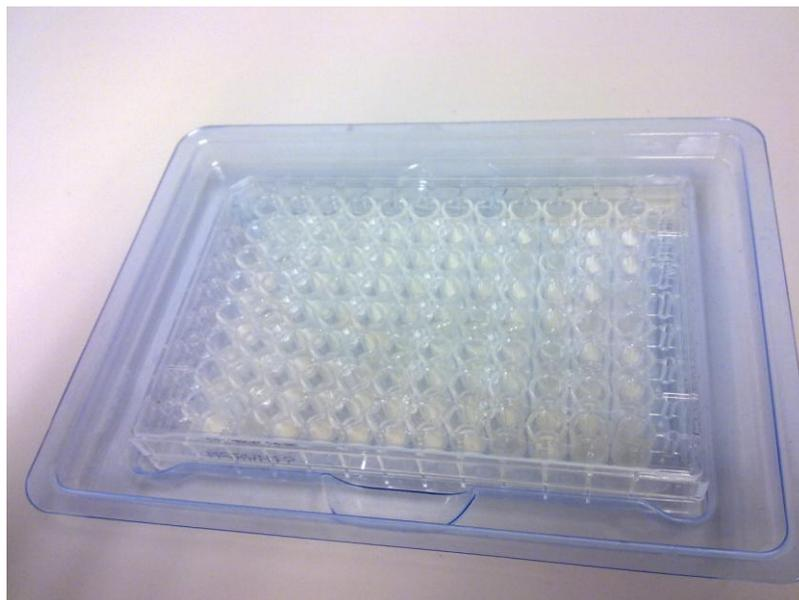
Figura 8. Placa de plástico con 1 x 96 pozos para muestras de suero
