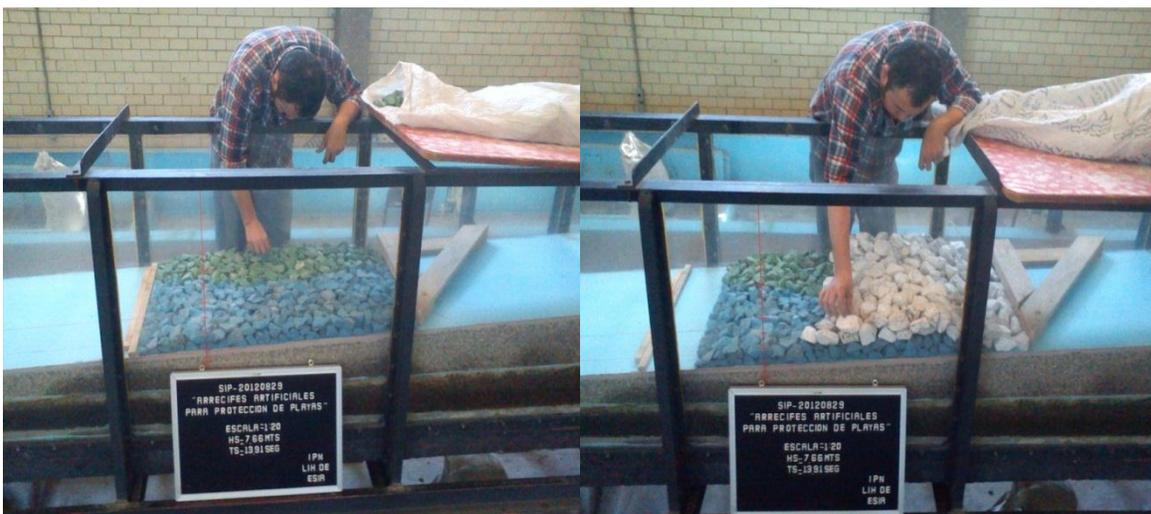
Fig. 5.13. Construcción de la estructura.
