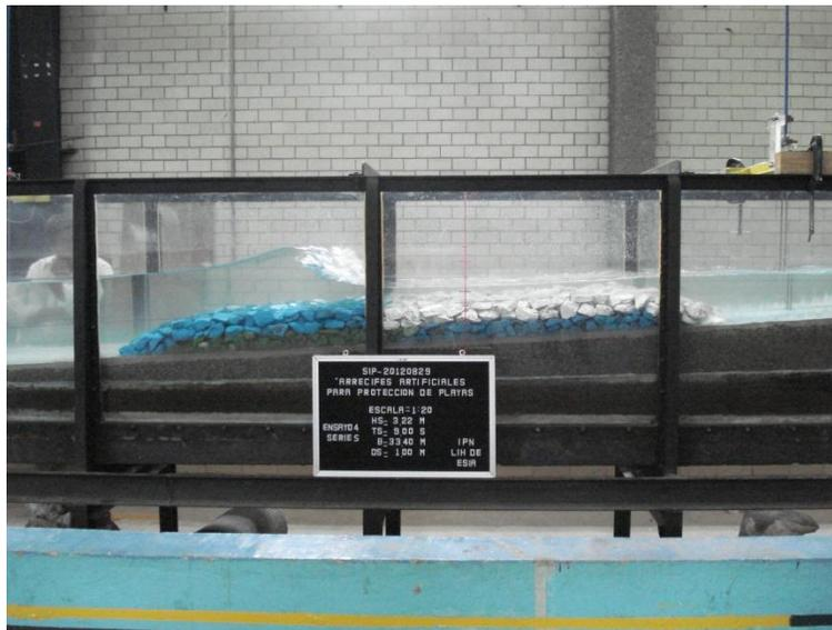
Fig. 5.21. Ancho de coronamiento de 34 m. sumergencia 1.00 m.
