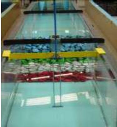
Fig. 5.5. Colocación de los sensores
