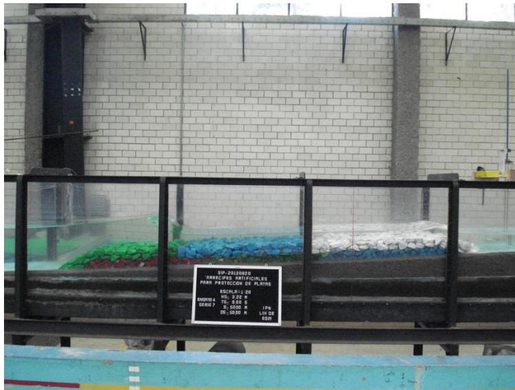
Fig. 5.23. Ancho de coronamiento de 50 m. sumergencia 0.50 m.
