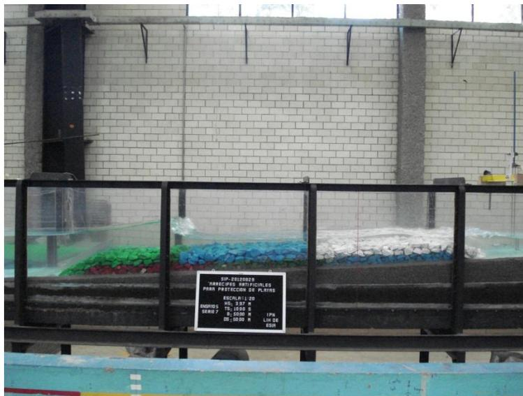
Fig. 5.24. Rompiente parcial sobre un ancho de coronamiento de 50 m, sumergencia 0.50 m.
