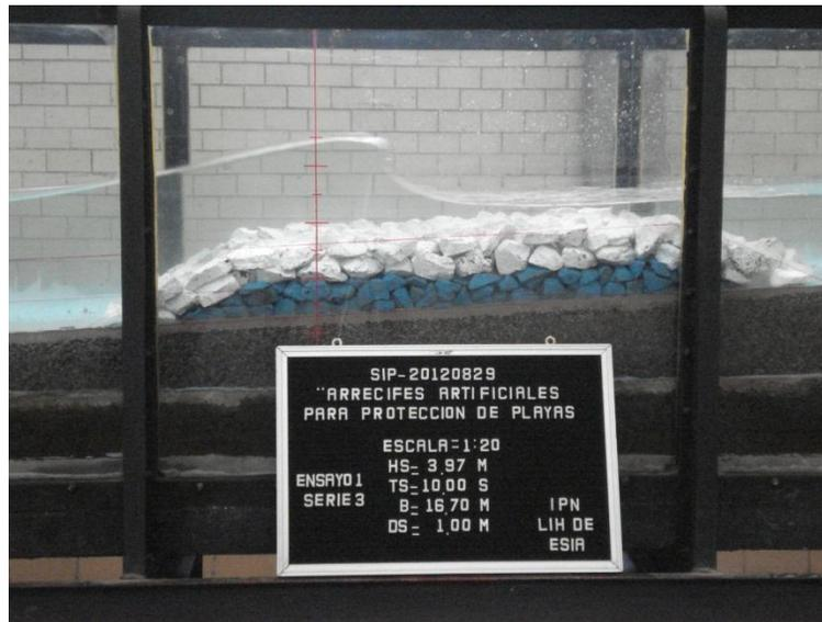
Fig. 5.18. Reducción considerable de la altura de ola sobre un ancho de coronamiento de 17 m, sumergencia 1.00 m.
