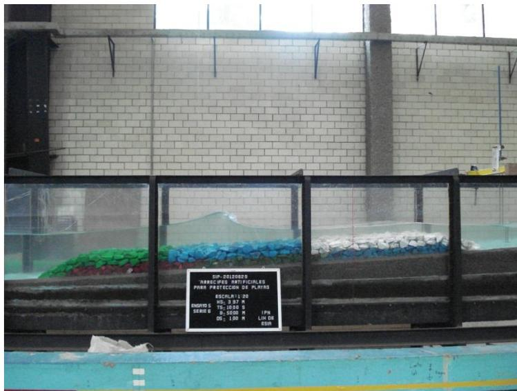
Fig. 5.26. Inicio de la formación de una rompiente total sobre un ancho de coronamiento de 50 m, sumergencia 1.00 m.
