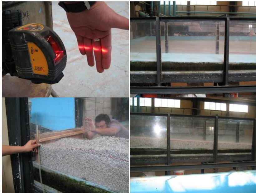
Fig. 5.10. Trazo de la línea de apoyo con nivel láser, relleno, compactación y nivelación.
