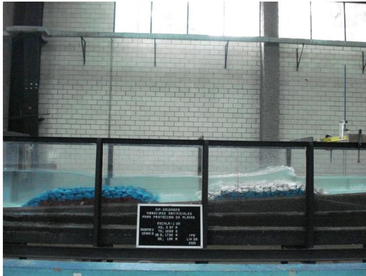
Fig. 5.30. Estructuras (2) de 17 m de ancho de coronamiento, sumergencia 1.00 m
