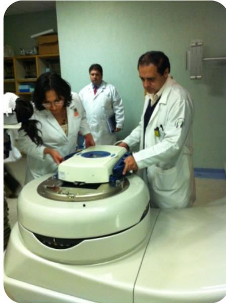
**Imagen M8.** Colocación del sistema de colimación micromultihojas M3 de BrainLab en el gantry del LINAC Varian del HGM, para posteriormente realizar la prueba Winston-Lutz.
