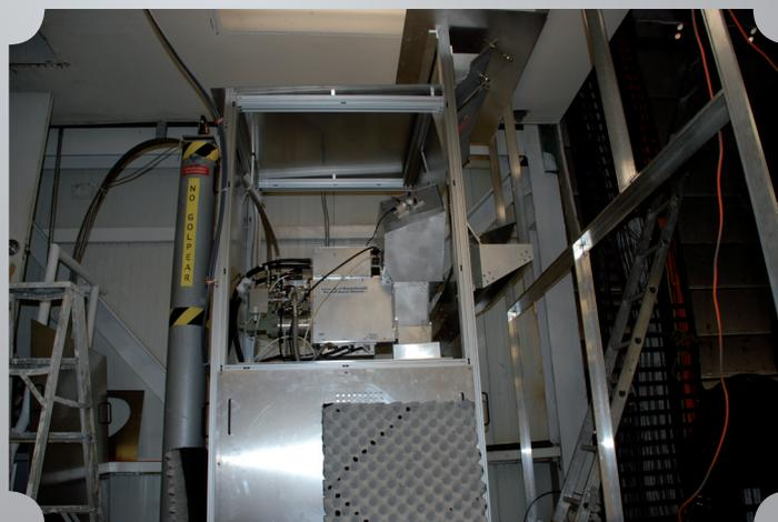
El Espectrómetro RSR en el cuarto de instrumentos del GMT
