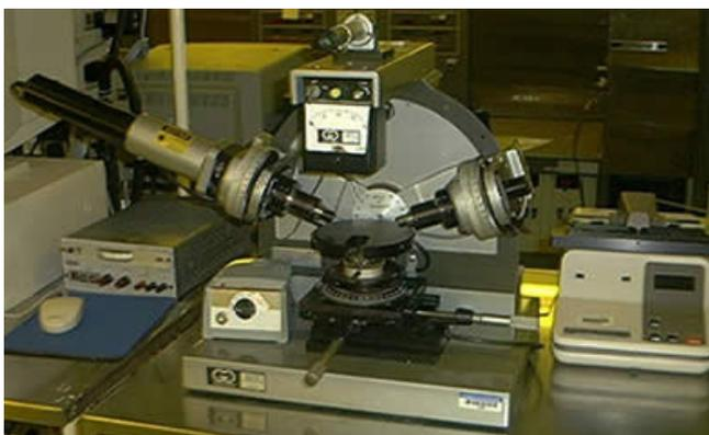
**Figura 3.6. Elipsómetro marca Gaertner modelo L117.**
