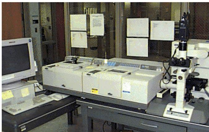
**Figura 3.8. Espectrofotómetro de transformada de fourier en el infrarrojo marca NICOLET modelo Magna-IR750.**
