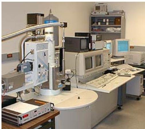
**Figura 3.10 Microscopio electrónico de barrido con detector de dispersión de rayos x marca JEOL modelo JSM6300.**
