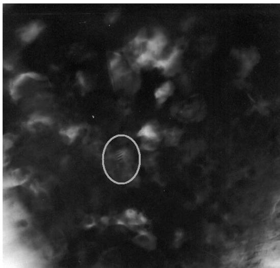
**Figura 4.33.** Micrografía de una película de ZnO depositada a 500 °C sin la adición de agua y con una molaridad de 0.5 g Zn(AcAc).
