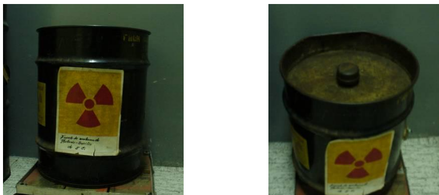
Figura IV.1. Fuente de neutrones de PuBe.
