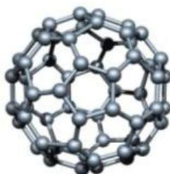
**Figura 1.7 Fullereno C<sub>60</sub>.**
