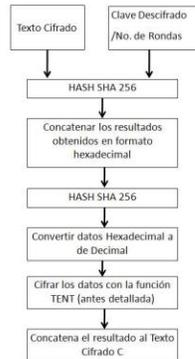
Figura 5. Diagrama del proceso de concatenación de la clave de cifrado y el número de rondas de cifrado, al mensaje cifrado.
