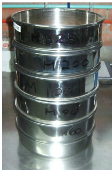
Figura 20. Tamizado de suelo.
