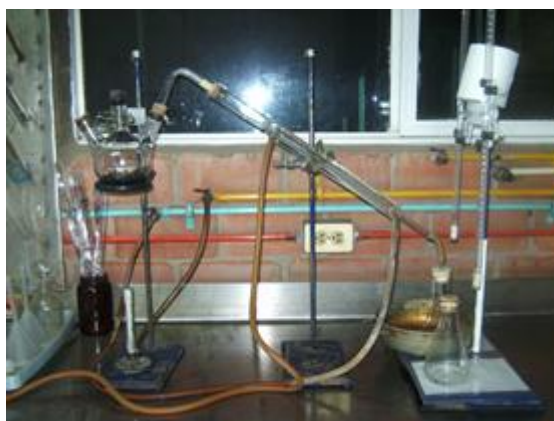
Figura 26. Dispositivo instalado para la determinación de Nitrógeno total.
