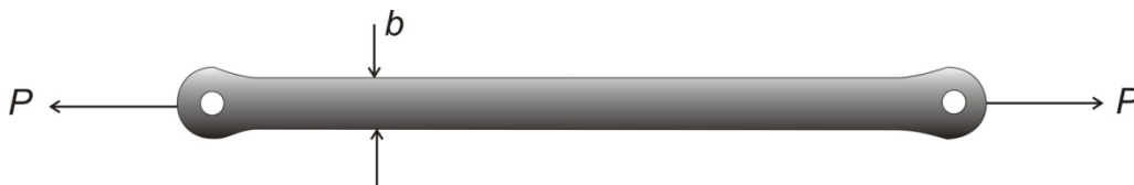
FIGURA (4.4) Biela del pistón de expansión.
