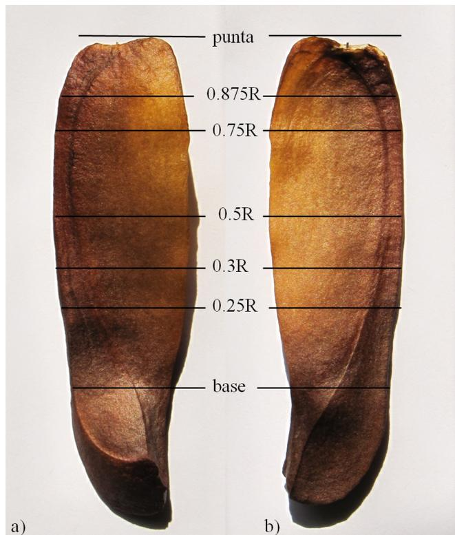
Fig. 2.3: Posiciones en las cuales se realizaron mediciones a lo largo de la envergadura: a) vista inferior de la semilla, b) vista superior de la semilla
