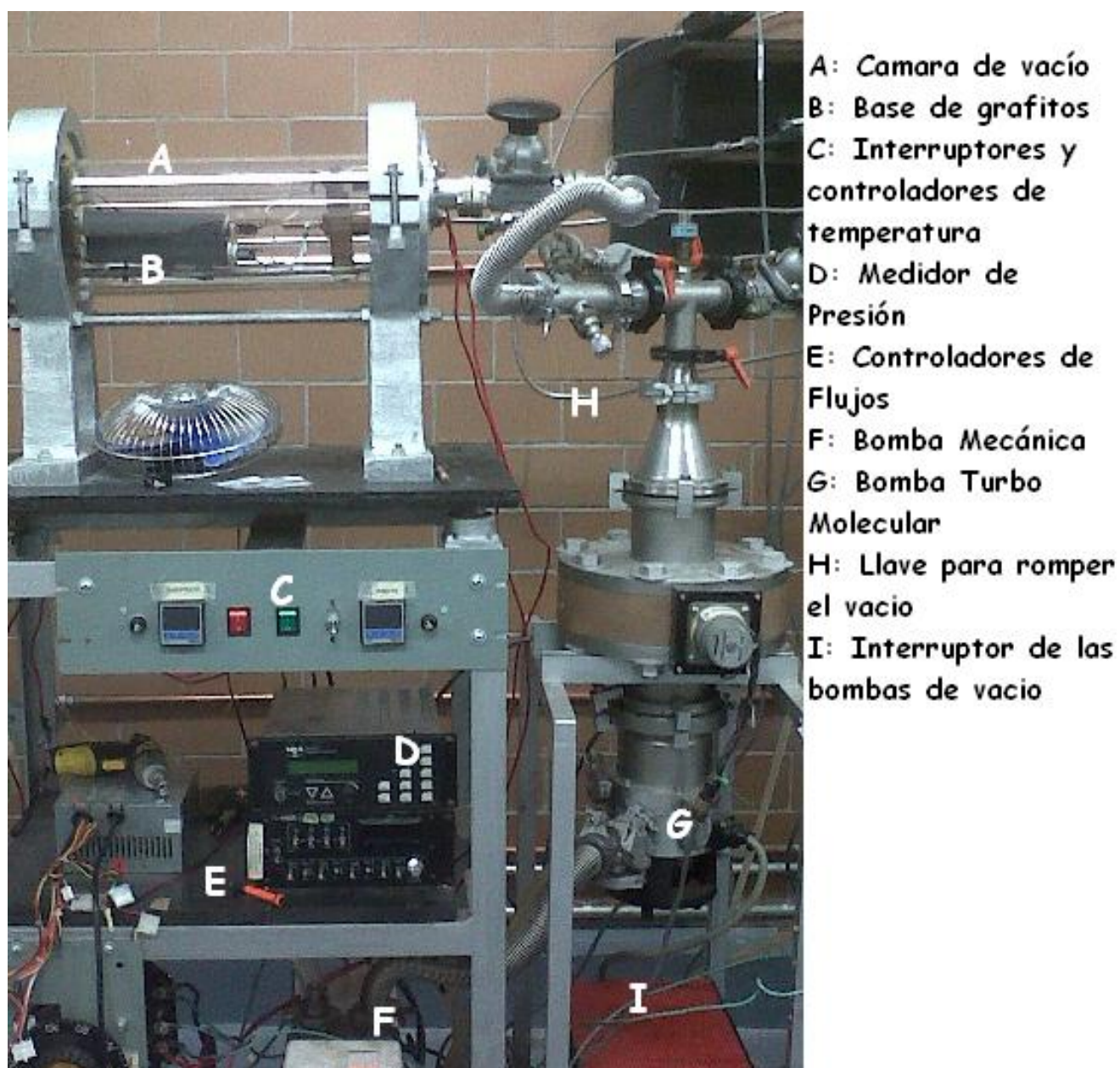
Figura 3.2: Equipo utilizado para el deposito de CdTe y CdCl_2 mediante la técnica de CSVT
