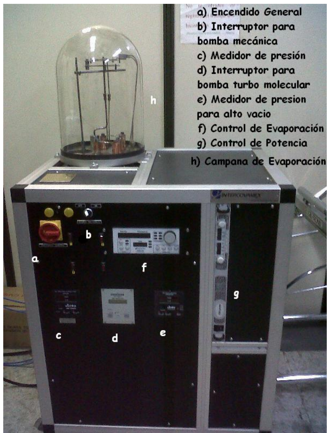
Figura 3.3: Equipo mediante el cual se realizó la evaporación térmica de Cu
