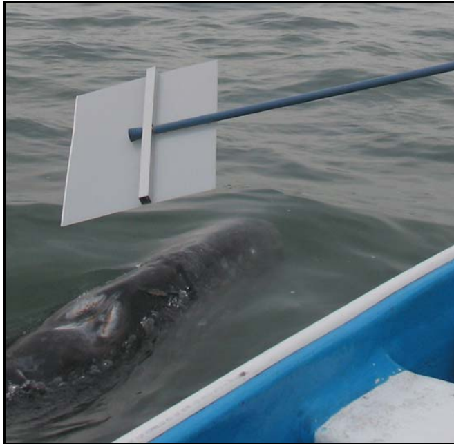
Fig. 2. Panel de acrílico sujeto a un tubo extensible de aluminio, implementado para recolectar muestras de soplo de cetáceos. En la foto se observa el muestreo de una cría de ballena gris.
