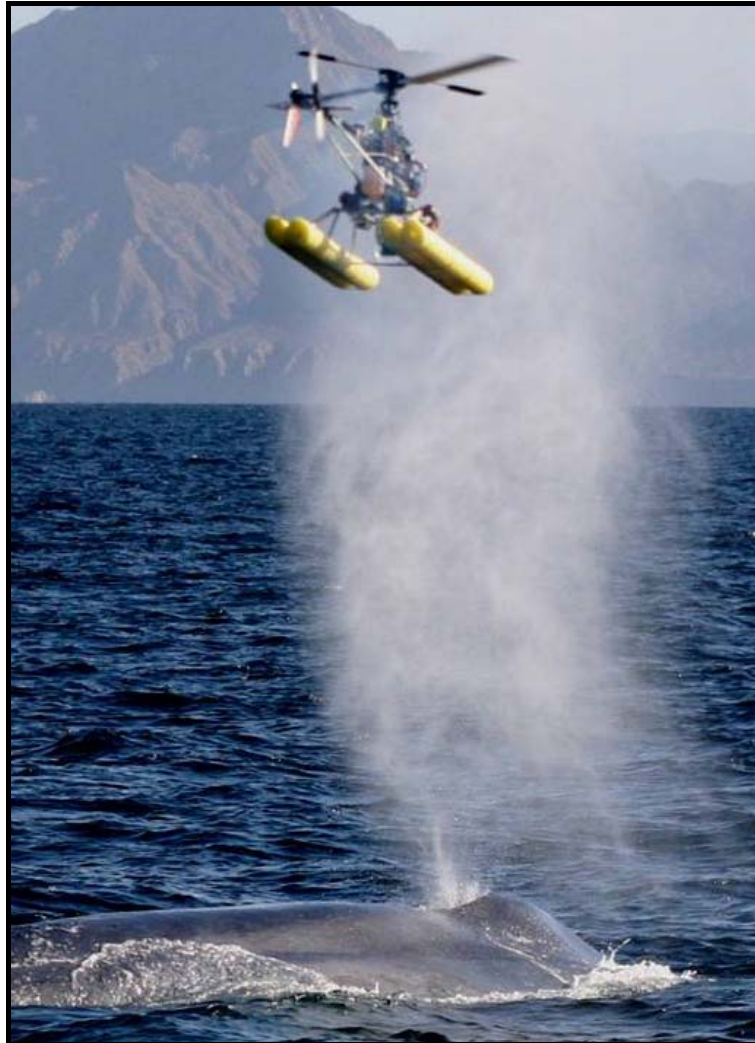
Fig. 4. Técnica aérea de recolección de muestras de sopro mediante helicóptero a control remoto. En la foto se observa el muestreo de una ballena azul.
