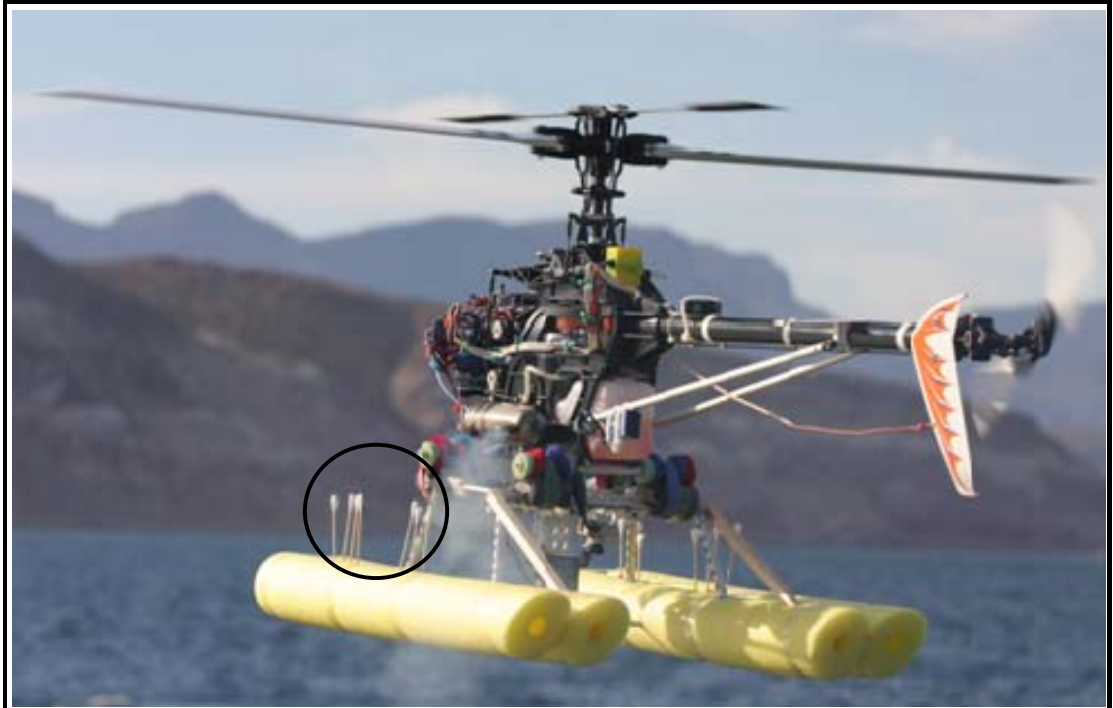
Fig. 3. Helicóptero a escala de control remoto marca Raptor 30 V2 Thunder Tiger, con hisopos estériles sujetos a los flotadores.
