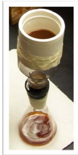
Fig. 8. Fotografía del proceso de filtración de muestras de heces con tamiz de nylon de 100 micras (Modificación a la técnica de Ritchie).
