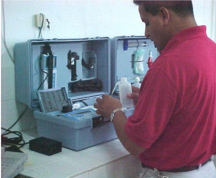
Figura 7. Equipo HACH/Drell 2000 utilizado para la medición y registro de parámetros fisicoquímicos del agua en las unidades experimentales.
