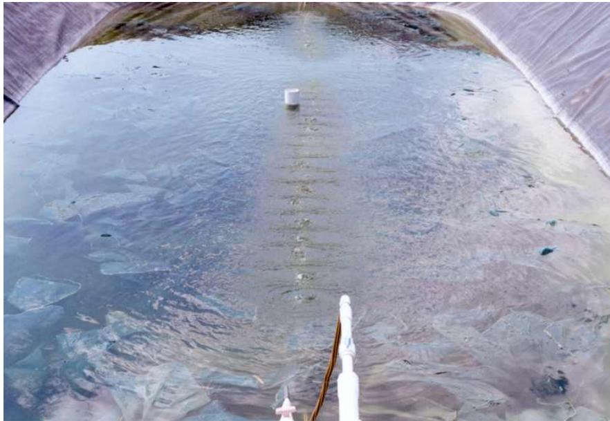
Figura 11. Estanque con aireación por la parte central del fondo del estanque. El nivel de aireación se controló con una válvula de cierre rápido.
