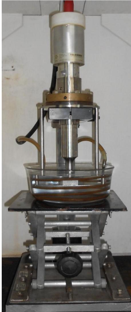
Figura 3.2 Cavitómetro TELSONIC ULTRASONICS DG-2000-2.
