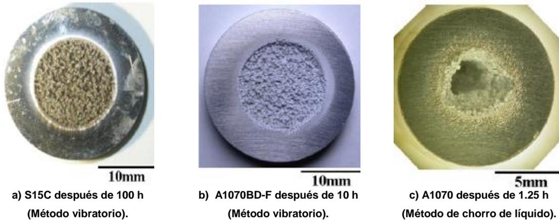
Figura 2.16 Especímenes erosionados.
