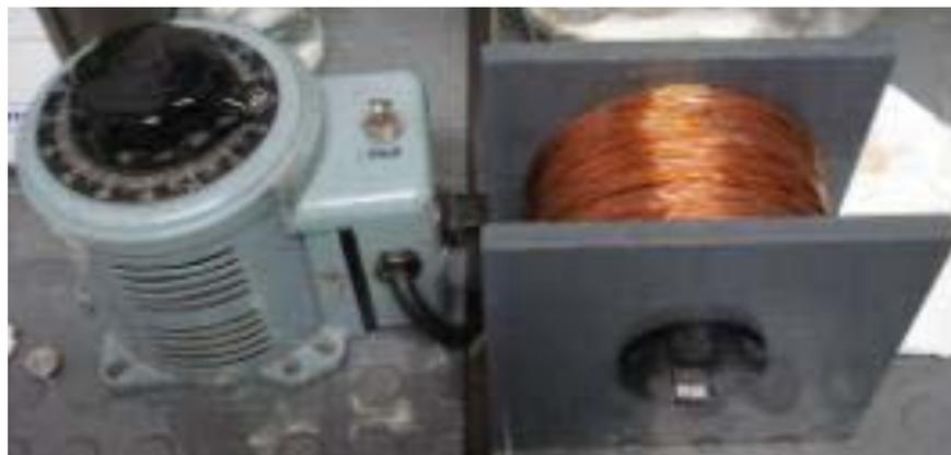
Figura 3.4 Desmagnetizador de especímenes.
