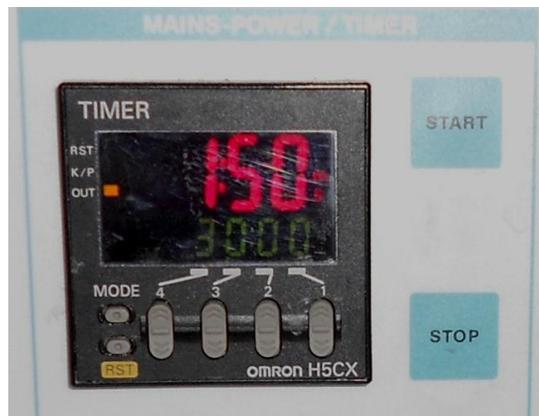
Figura 3.8 Programación del tiempo de prueba
