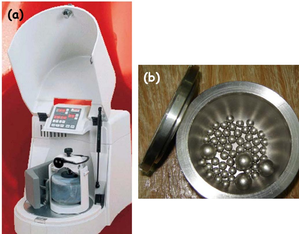
Figura 3.6. (a) Molino FRITSCH-P6 y (b) contenedor y medios de molienda.
