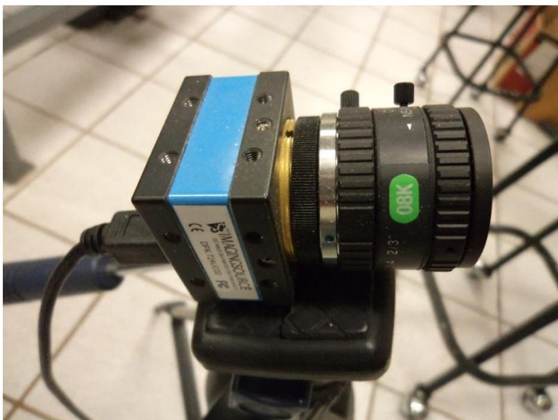
*Figura 4.5 cámara para la toma de las imágenes del patrón.*
