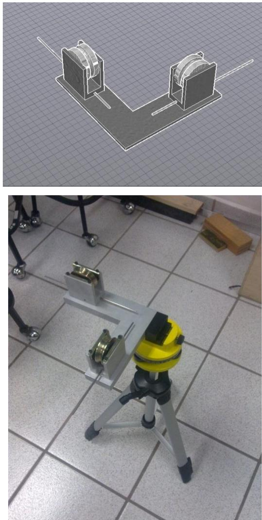
*Figura 4.9 plataforma para aplicación de fuerzas en los ejes X e Y, en la parte superior se observa el dibujo de la plataforma en CAD, en la parte inferior la plataforma ya construida y montada sobre el trípode.*
