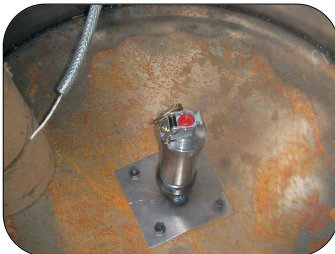
Figura 23. Colocación del “recipiente piloto” en el fondo de la fosa de pruebas (tambo).
