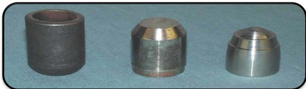
Fig. 15. Diferentes etapas del proceso de fabricación del cuerpo de la ojiva (recipiente) OCSW.
