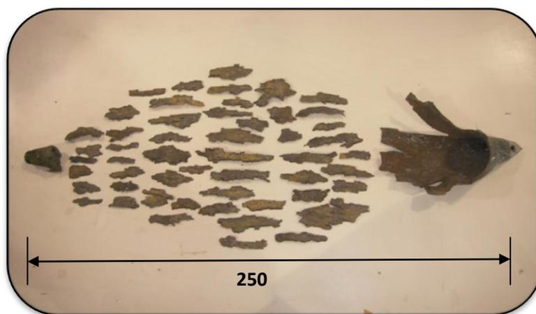
Fig. 4. Fragmentación de recipiente utilizado en un mortero calibre 120 mm.
