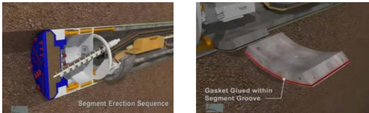
Imagen 10.-Colocación de segunda dovela (izq), detalle de una dovela (der)
