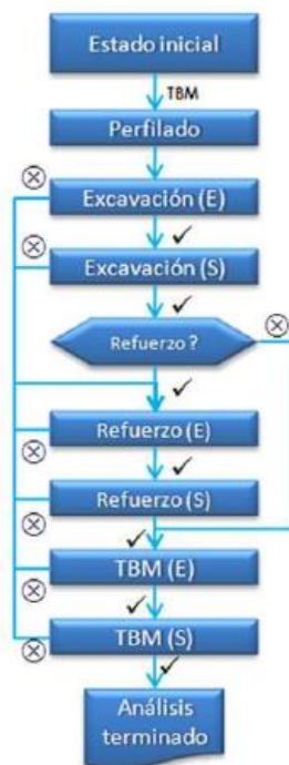
Figura 4 Diagrama de flujo para el análisis con sismo en la etapa de construcción
