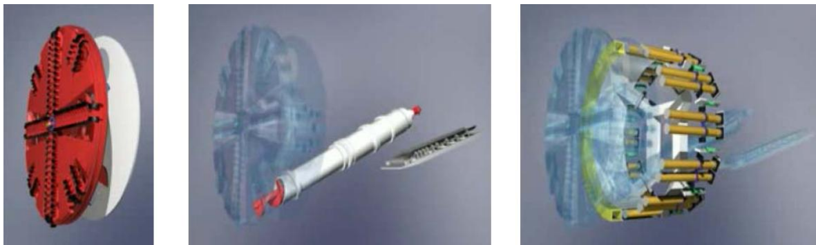
Imagen 7.-Cámara de excavación (izq), tornillo sin fin y banda transportadora (centro), gatos hidráulicos (der)
