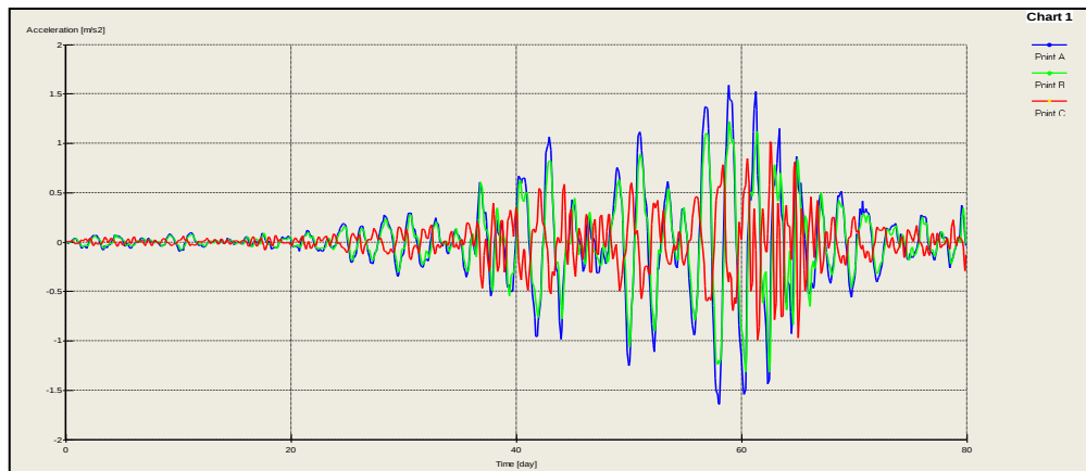
Figura 22 Comparativa de respuesta dinámica entre puntos con ancho de región 15 diámetros de túnel
