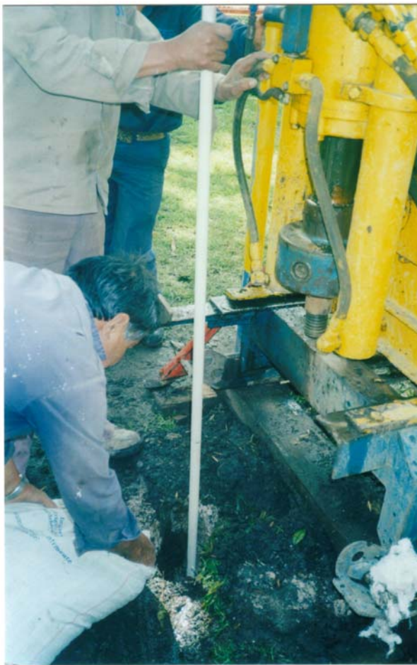
Figura 10. Instalación de la sonda y piezómetro.
