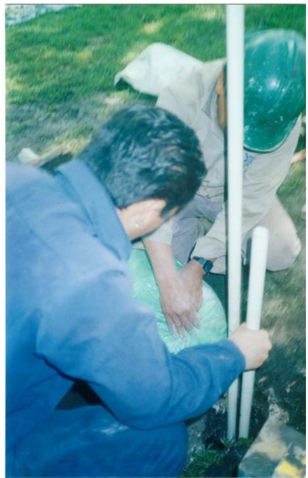
Figura 10. Instalación de la sonda y piezómetro.
