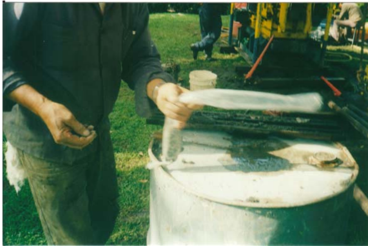
Figura 11. Recuperación de muestras alteradas por medio de tubo partido
