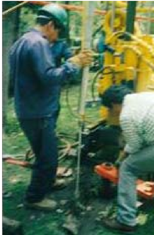
Figura 13. Procedimiento de prueba con veleta
