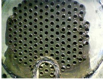
Figura 26 corrosión generalizada en el espejo del intercambiador por combinación de materiales.
