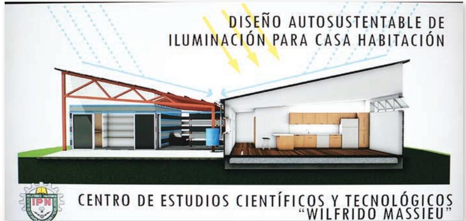
En la parte superior se instaló un aislante negro y en la parte superior se instaló una cúpula que permite que llegue mejor el reflejo del sol.
