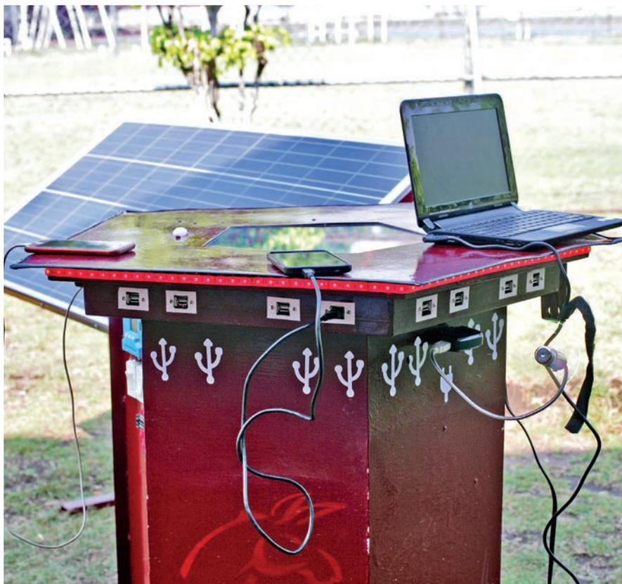
El panel solar que alimenta todos los componentes y elementos del prototipo será colocado en el domo de la ludoteca con dirección al Sur para mayor aprovechamiento de la radiación
