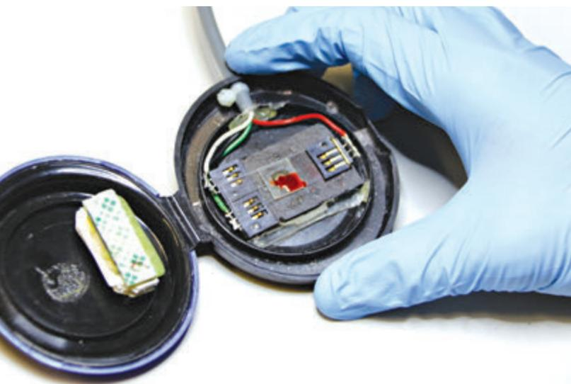
👍 La muestra y el dispositivo se introduce en un Housing para medir las propiedades eléctricas de ésta
