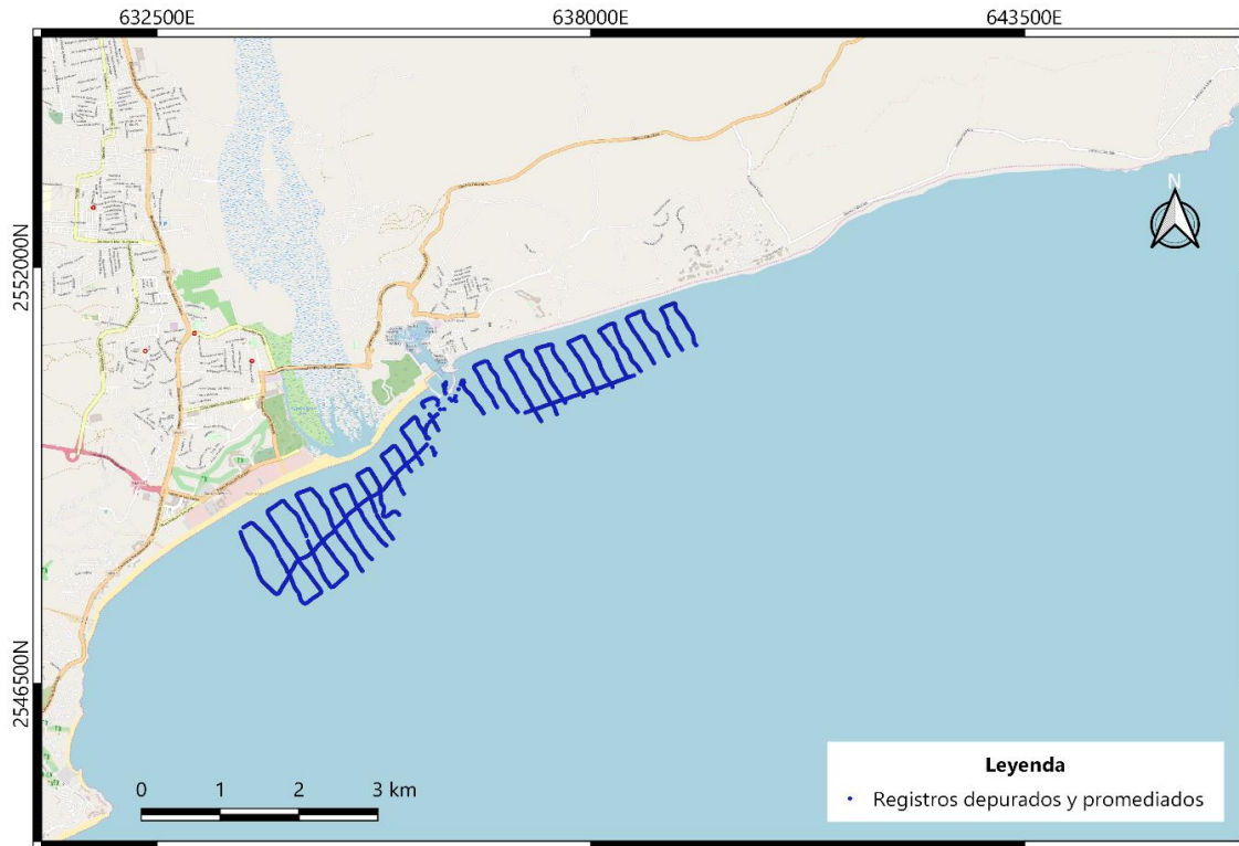
Figura 13. Registros del levantamiento batimétrico depurados y promediados.
