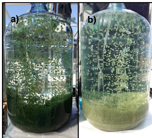
Fig. 19 Establecimientos de los dos tipos de bioencapsulados en medio de cultivo BG11 a) encapsulado de Fischerella en Ca-Alginato (EAF), b) encapsulado de Fischerella en Ca-Alginato-Chitosano (EAQF).
