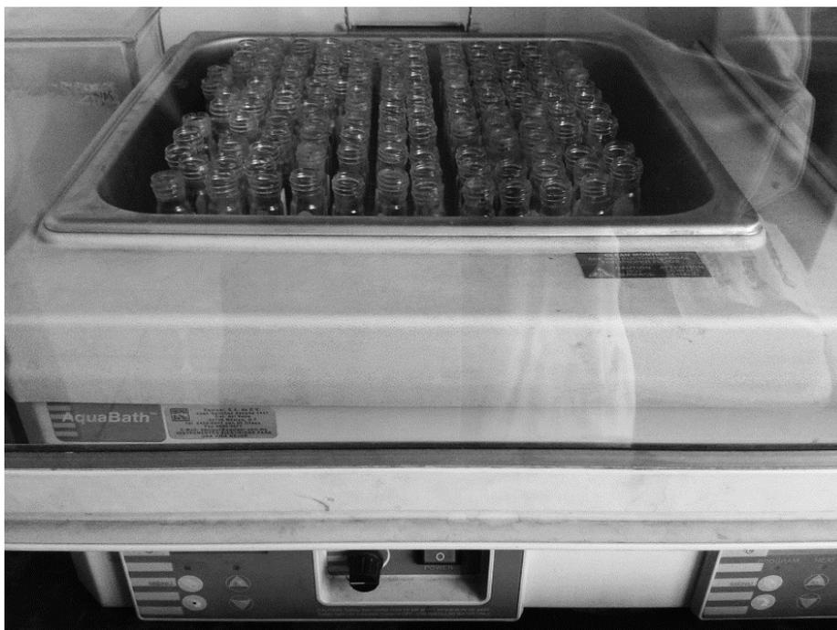
**Figura 4.** Músculo, hígado y presas enteras de huachinango del Pacífico *Lutjanus peru*, colocadas en tubos de ensaye parcialmente sumergidos en agua a temperatura de 160°C para su digestión.
