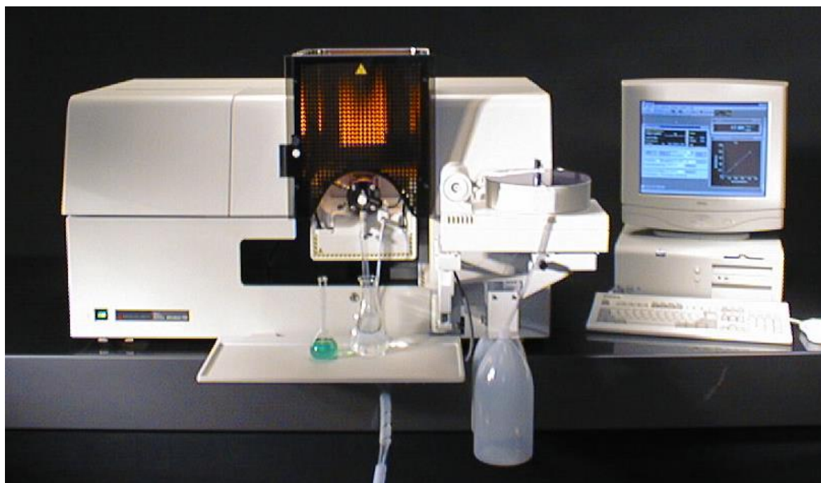
Figura 5. Espectrofotómetro de absorción atómica Perkin Elmer Analyst-700.
