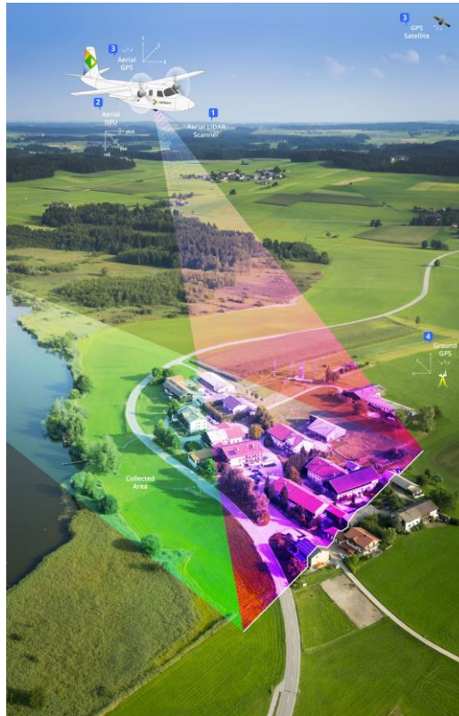
Figura 17. Se mide la distancia al suelo desde un vehículo aéreo posicionado por GPS (tomada de https://www.sanborn.com/lidar-operating-principles ).
