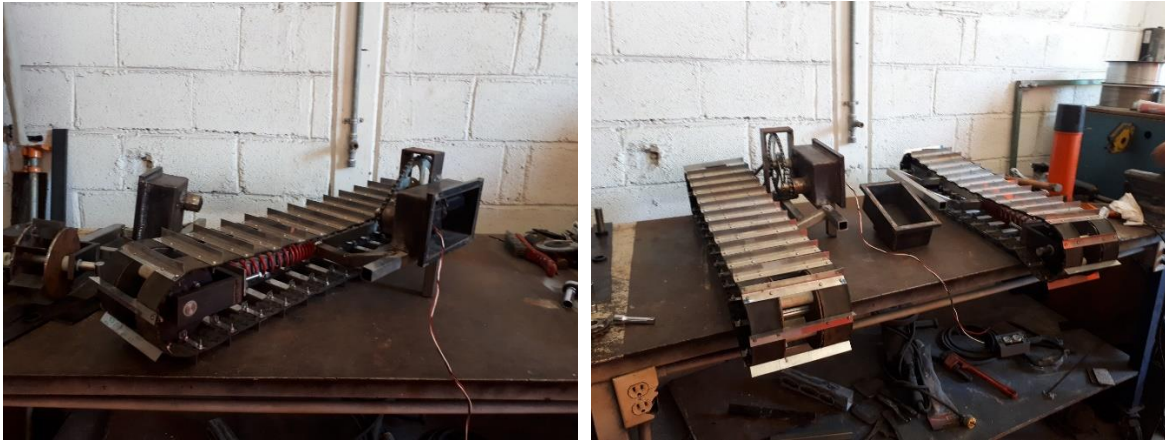
Figura 40. En proceso de desarrollo de las ruedas tipo oruga.
