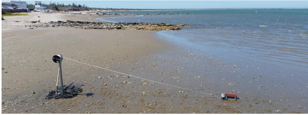
Figura 25. Equipo hermético con sensores de inclinación siendo recobrado con un cabo.
