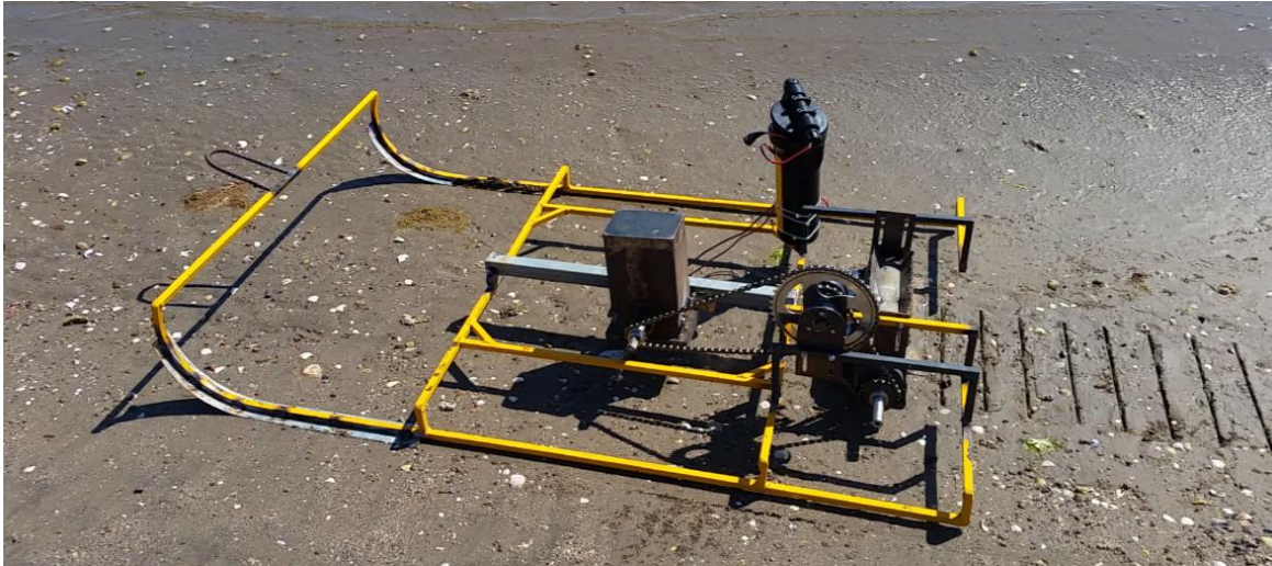
Figura 33. Pruebas de sistema de locomoción en playa El Comitán, prototipo preliminar.
