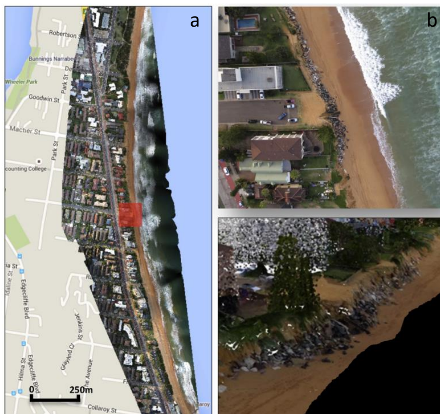
Figura 16. Resultado obtenido con fotogrametría en una playa. a) Área muestreada; b) Acercamiento a playa y modelo digital 3D (tomada de Turner et al., 2016).
