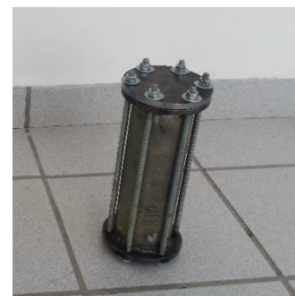
Figura 26. Contenedor hermético para proteger inclinómetro.
