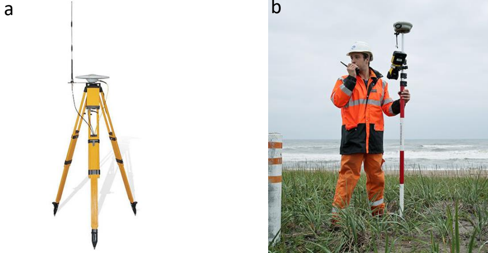
Figura 13. Equipo RTK-GPS marca Trimble. (a) Estación base (tomada de https://dronak.com/equipamiento-de-drones ); (b) Estación móvil (tomada de http://www.fertoing.com/equipment/geodetic/trimbler8 ).
