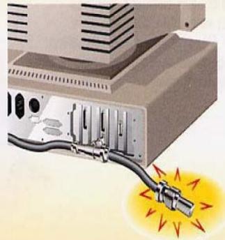
El tipo de terminador requerido depende del cable utilizado en la red.
