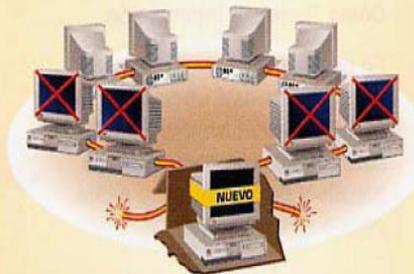
Las demás máquinas en las redes no pueden intercambiar información mientras el cable esté roto.
