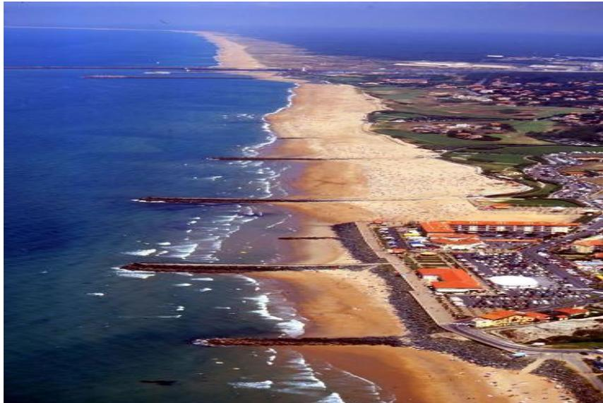
Fig. 7 Obras de protección perpendiculares a la línea de costa
