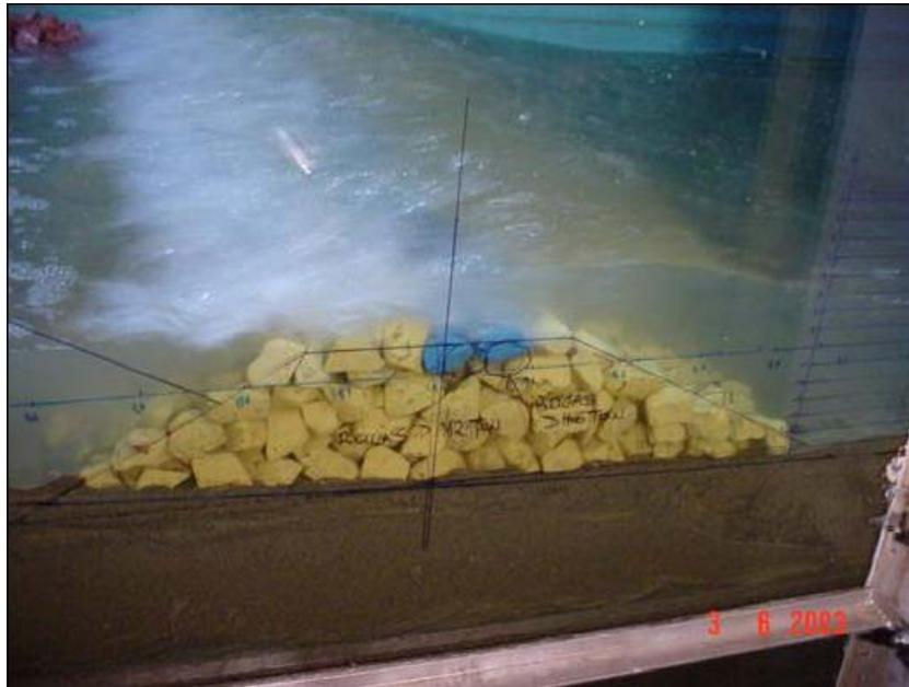
Fig. 15 Experimentación de un rompeolas sumergido en un canal de oleaje irregular
