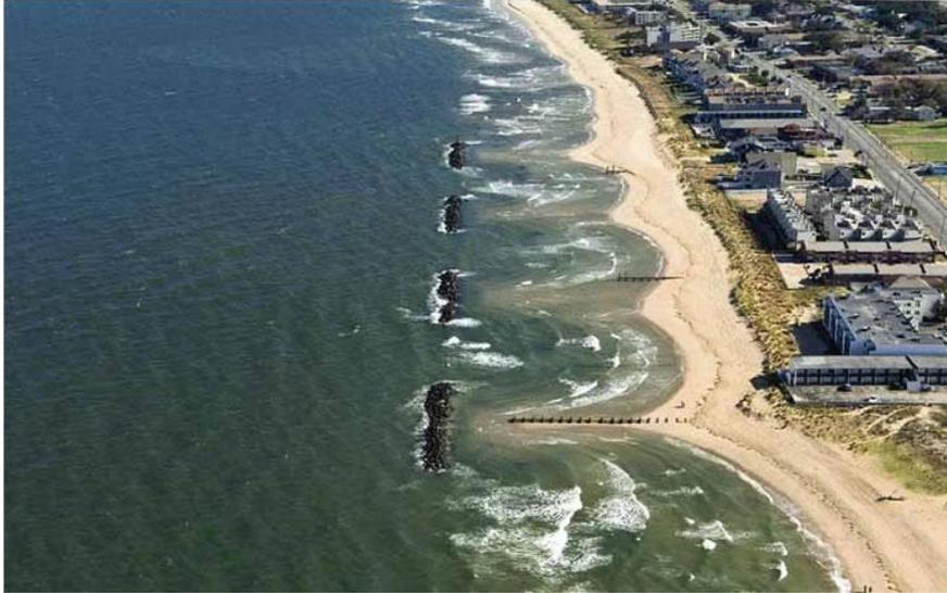
Fig.6 Obras de protección paralelas a la línea de costa
