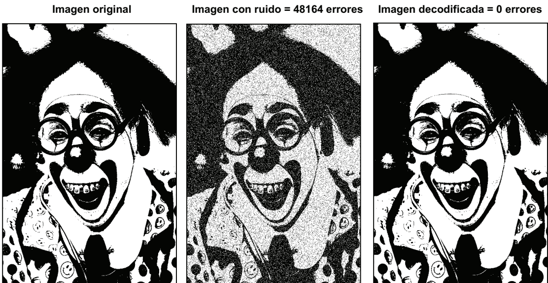
Figura 5.27. Experimento 4: Comparación: a) Imagen original, b) Imagen con ruido (48164 errores), c) Imagen recuperada desde el DSP.
