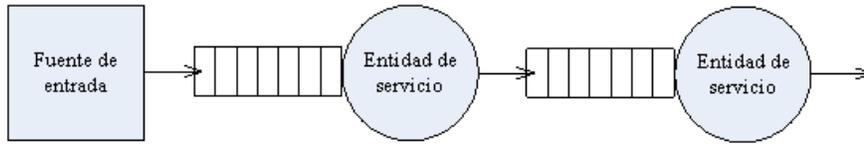
Figura 4.1: Red de dos  $M | M | 1$  seriadas.
